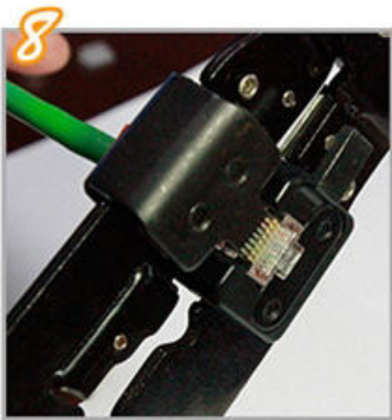
8. 將水晶頭放入工具鉗相對應的卡口內，鉚壓金片
